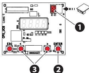
A felhasználókra és a berendezés konfigurálására vonatkozó adatok elmenthetők egy MEMORY ROLL kártyára.
